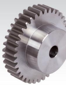
Exemple de commande : n° art. 213 010 00, roue cylindrique, 11SMnPb30, module 1,0, 10 dents
